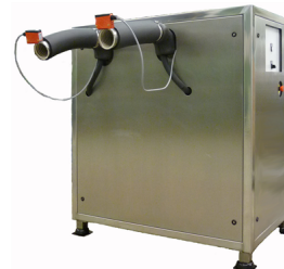
Productor de hielo con maniobra y carcasa de acero inoxidable
